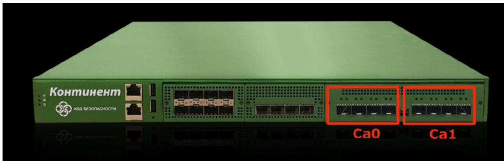
При использовании DAC-кабеля на криптокоммутаторах КК 1 и КК 2 в ПУ ЦУС настраиваются только два интерфейса: `са0` — внешний и `са1` — порт криптокоммутатора.
